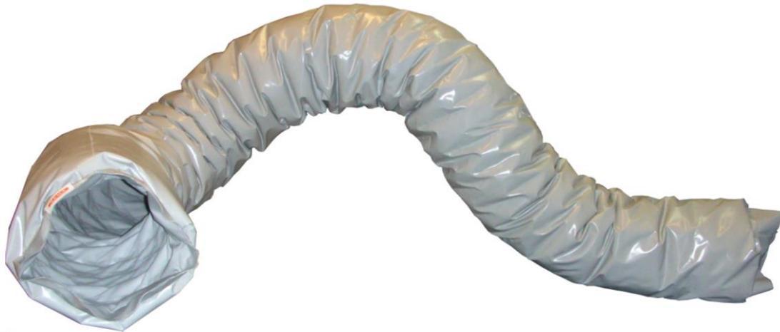
La tubazione è costituita da due strati esterni di PES con isolamento interno in vetroresina e rinforzata da spirale di acciaio. La tubazione garantisce un'alta flessibilità e ottime prestazioni di isolamento. Gli spezzoni terminano, a entrambe le estremità, con manicotti non isolati da 100 mm di lunghezza che ne facilitano l'installazione.
